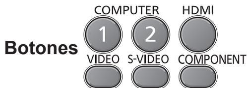
**Pulse el botón (<COMPUTER 1>, <COMPUTER 2>, <HDMI>, <VIDEO>, <S-VIDEO> o <COMPONENT>) del control remoto.**
