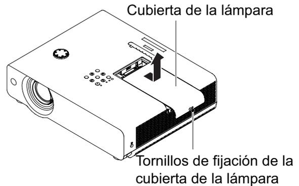
2) **Use un destornillador Phillips para aflojar el tornillo que surge esta la cubierta de la lámpara y retire la cubierta de la lámpara.**
