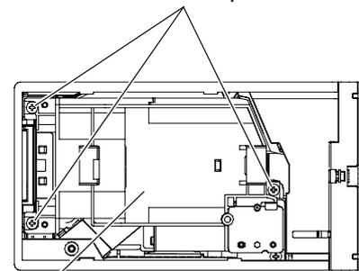
4) **Inserte la nueva unidad de lámpara en la dirección correcta. Apriete firmemente los tres tornillos de fijación de la unidad de lámpara con un destornillador Phillips.**
