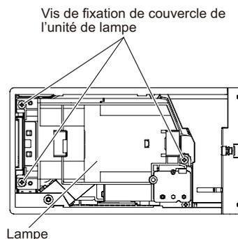
4) **Insérez la nouvelle lampe dans le bon sens. Serrez fermement les trois vis de fixation de la lampe avec un tournevis cruciforme Phillips.**
