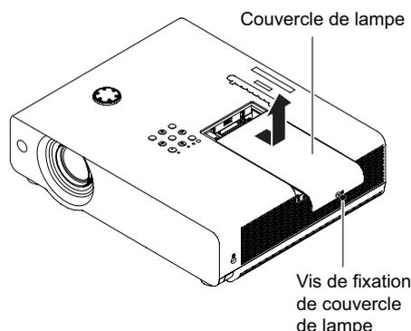
2) **Utilisez un tournevis Phillips pour dévisser la vis de fixation du couvercle de la lampe puis retirez le couvercle de la lampe.**
