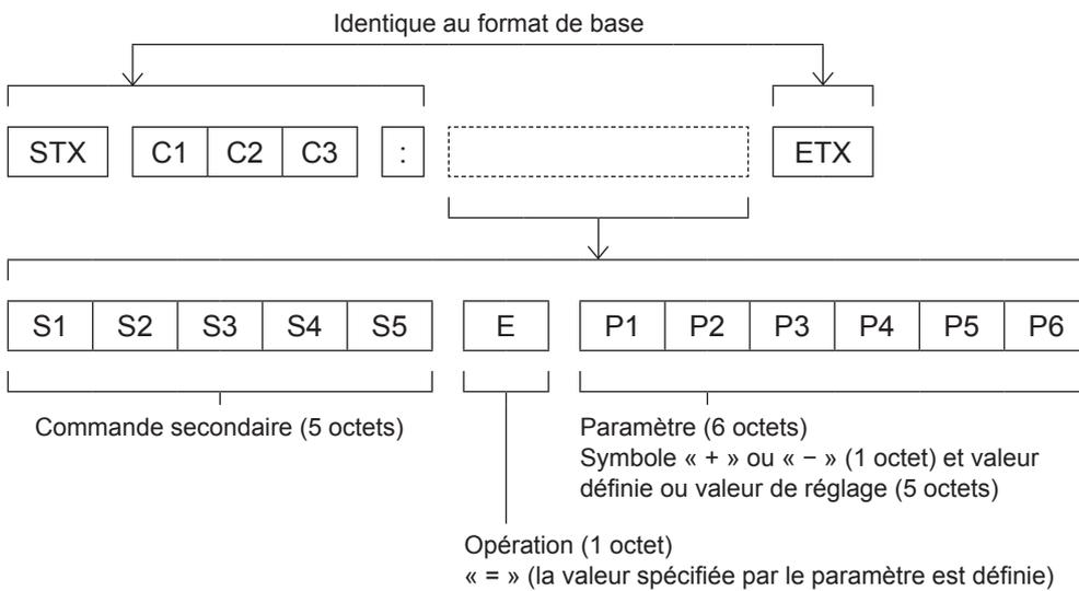
\*: Lorsqu'une commande ne nécessitant pas de paramètres est envoyée, l'opération (E) et le paramètre ne sont pas nécessaires.
