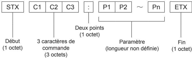
\*: Lors de l'envoi d'une commande sans aucun paramètre, un deux-points (:) devra être transmis.
