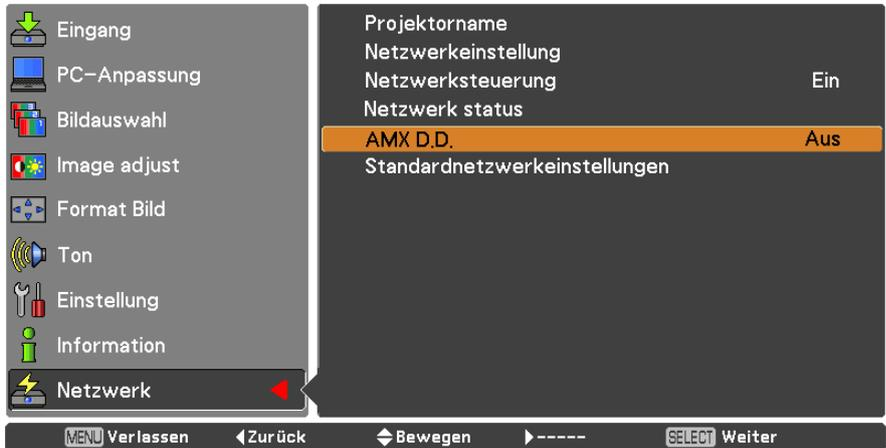
**2** Drücken Sie die Taste <SELECT> oder die Taste ►, um [Ein] oder [Aus] auszuwählen, damit der Projektor von AMX Device Discovery/Geräteerkennung erkannt werden kann. Weitere Details finden Sie unter <http://www.amx.com/>.
