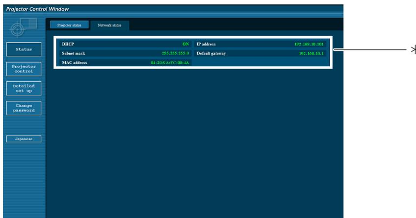
\* Zeigt die Konfigurationdetails von Kabel-LAN an.
