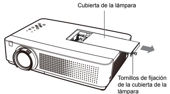
2) **Use un destornillador Phillips para aflojar el tornillo que surge esta la cubierta de la lámpara y retire la cubierta de la lámpara.**
