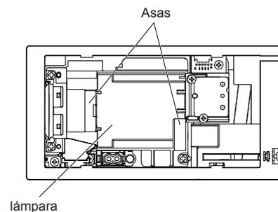
4) **Inserte la nueva unidad de lámpara en la dirección correcta. Apriete firmemente los tornillos de fijación de la unidad de lámpara con un destornillador Phillips.**
