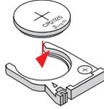
Entfernen Sie die alte Lithium-Knopfzelle und installieren Sie eine Neue (CR2025). Achten Sie darauf, dass die Seite mit „+“ nach oben zeigt.
