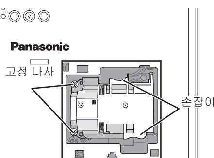
**4 “찰칵” 하고 제자리에 들어갈 때까지 램프 장치를 밀어넣은 다음 장치가 정확하게 설치 되었는지 확인합니다. 십자 드라이버로 2 개의 램프 장치 고정 나사를 단단히 조입니다.**
