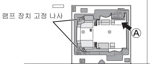
**5 램프 장치 덮개를 부착하고 십자 드라이버로 1개의 램프 장치 덮개 고정 나사를 단단히 조입니다.**
