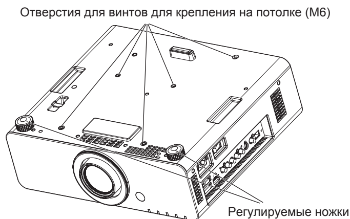
Рис. 1 Местоположение отверстий для винтов для крепления на потолке и регулируемых ножек
