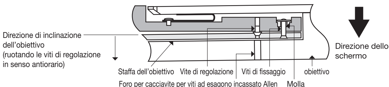
Figura 3 : Vista trasversale di parte del dispositivo di montaggio dell'obiettivo
