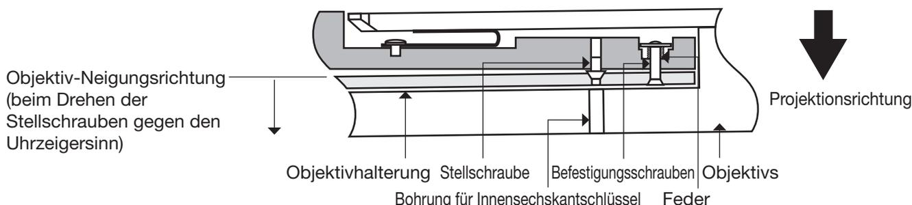
Ist das Objektiv schwer oder der Projektor in geneigter Position montiert, kann sich das Objektiv neigen, was zu einer ungleichmäßigen Bildschärfe führt. Sehen Sie sich in einem solchen Fall die Abbildung 4 und Tabelle unten an und führen Sie die nachfolgend beschriebene Einstellung durch.
