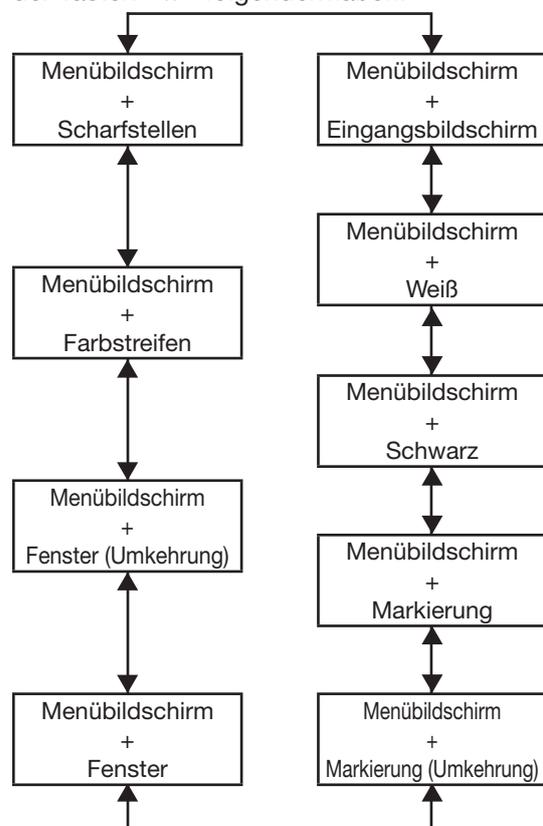
Der Projektor verfügt über acht verschiedene Testbilder, mit denen der Zustand des Geräts geprüft werden kann.
