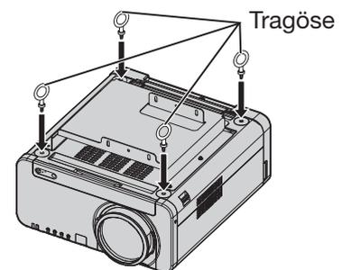
**4. Montieren Sie jedes der vier Kabel an die vier Tragösen.**
