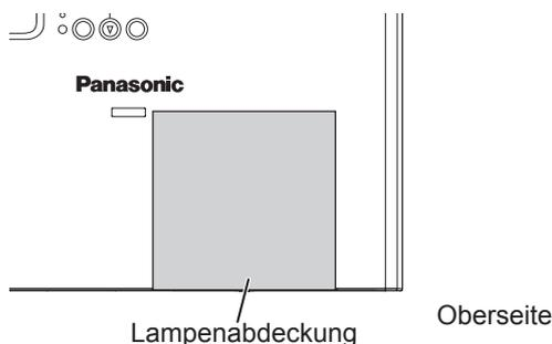
**3** Lösen Sie die drei Befestigungsschrauben der Lampe mit einem Kreuzschlitzschraubendreher. Ziehen Sie die gebrauchte Lampe vorsichtig aus dem Projektor.
