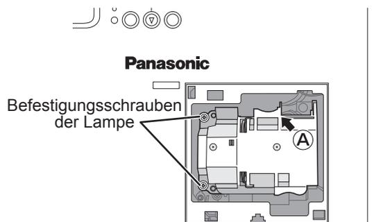
**5** Setzen Sie die Leuchtenabdeckung an und schrauben Sie die 1 Leuchtenabdeckung mit einem Kreuzschlitzschraubenzieher fest.
