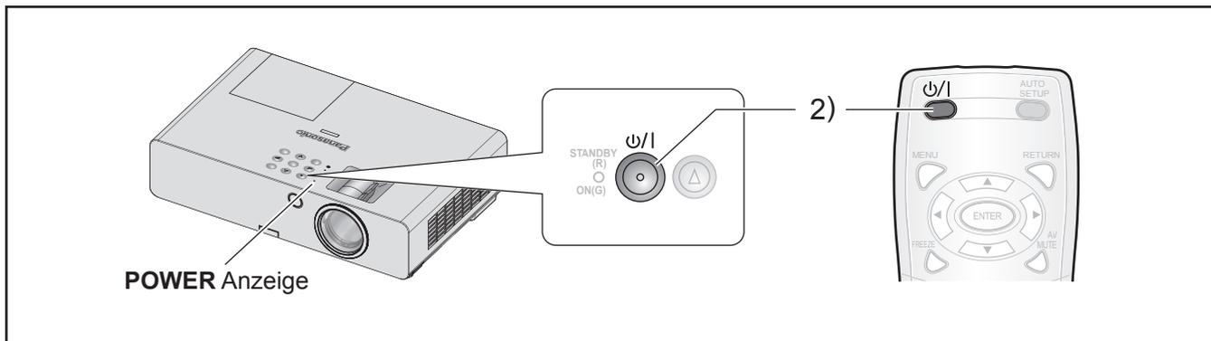
Stellen Sie vor dem Einschalten des Projektors sicher, dass das Netzkabel und alle anderen Geräte ordnungsgemäß angeschlossen sind und öffnen Sie den Objektivdeckel. (⇒ Seite 18)
