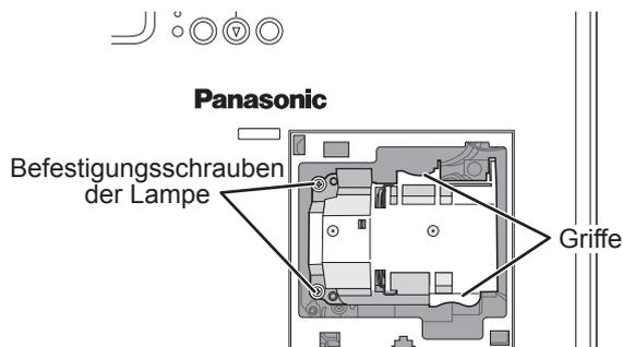
**4** Drücken Sie die Lampe hinein, bis sie einrastet, und stellen Sie sicher, dass sie ordnungsgemäß sitzt. Ziehen Sie die drei Befestigungsschrauben der Lampe mit einem Kreuzschlitzschraubendreher fest an. Beim Einschieben der Lampe drücken Sie **A** nicht zu stark.
