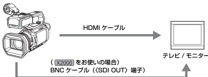
• 市販の HDMI ケーブルは、High Speed HDMI ケーブルをご使用ください。なるべく 3 m 以内のケーブルのご使用をお勧めします。
