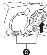
■ Подключение внешнего микрофона к разъему <MIC>
