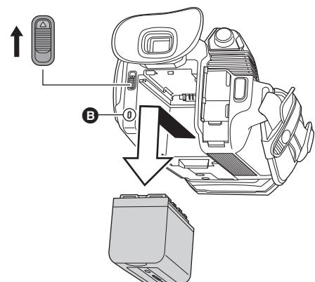
Bewegen Sie den Akku-Entriegelungsschieber in Pfeilrichtung und nehmen Sie den Akku nach der Entriegelung heraus.
