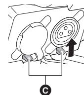
**■ Anschließen eines externen Mikrofons an den <MIC>-Anschluss**
