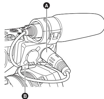
**5 Schalten Sie den <INPUT1>-Schalter passend zum angeschlossenen Mikrofon um.**
