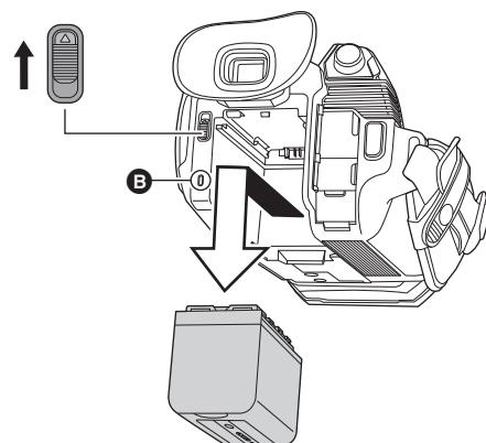
Déplacer le levier d'éjection de la batterie dans le sens de la flèche et retirer la batterie lorsqu'elle est débloquée.
