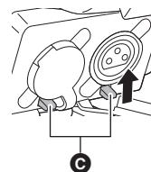
■ Montaje del micrófono externo en el terminal <MIC>
