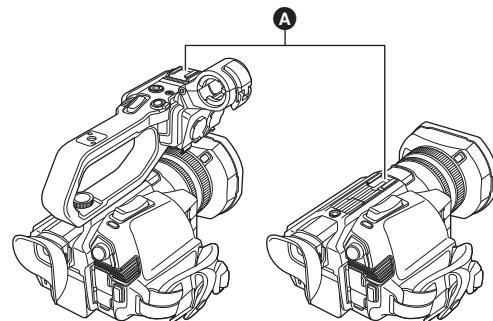
2 Conecte el cable del micrófono al terminal <MIC>.
