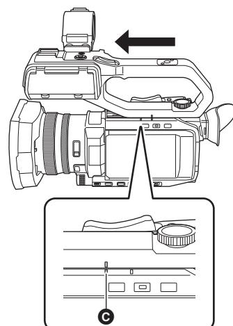
**5** Tout en appuyant sur la vis de montage de l'unité poignée, la tourner dans le sens de la flèche ② jusqu'à ce qu'elle s'arrête.
