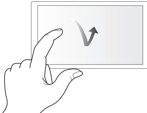
Une action qui consiste à appuyer sur et à relâcher l'écran LCD. Il est possible de sélectionner un élément ou une icône ou bien d'exécuter un élément.
