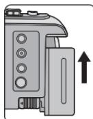
バッテリーをバッテリー取り付け部に当てる状態で、上方向に「カチッ」と音がするまで押し込む
