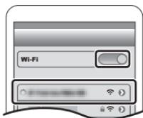
**4 スマートフォンの Wi-Fi 設定画面で、本機に表示されている SSID を選ぶ**
