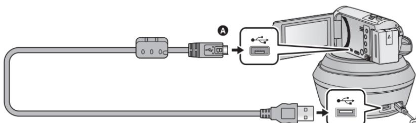
**A** Mettez le côté du symbole vers le haut afin de brancher la prise micro B du câble USB au port USB de cet appareil.
