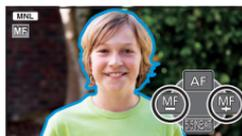
La zone de mise au point est affichée en bleue. L'écran normal revient environ 2 secondes après la fin de la mise au point du sujet.
