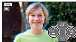
Der scharfgestellte Bereich wird in blau angezeigt. Die normale Anzeige kehrt ca. 2 Sekunden nach der erfolgreichen Scharfstellung des Objekts zurück.
