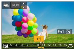
**Prise de photos avec un arrière-plan flou (fonction de commande de défocalisation)****1 Après avoir appuyé sur ▲ à l'étape 1 de « Réglage de la luminosité (exposition) » (ci-dessus), appuyez sur la touche [Fn1] pour afficher l'écran de réglage.****2 Tournez la molette arrière pour régler.**
