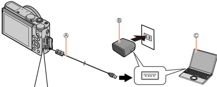
**Lorsque vous chargez l'appareil photo, branchez le câble de connexion USB (fourni) dans la prise [USB/CHARGE].**
