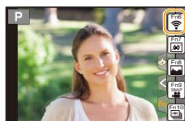
相機沒有連接到 Wi-Fi 時，按 [Wi-Fi]。然後，相機會準備好連接到智慧手機。可以將相機直接連接到智慧手機。(P253)
