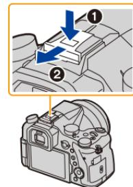
**Retirez le couvercle de la griffe porte-accessoires en le tirant dans le sens indiqué par la flèche ② tout en appuyant dessus dans sens indiqué par la flèche ①.**
