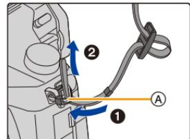
**2 Passez l'extrémité de la bandoulière à travers l'anneau en suivant la flèche puis passez-la à travers la butée.**
