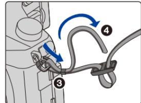
**3 Passez l'extrémité de la bandoulière à travers le trou de l'autre côté de la butée.**
