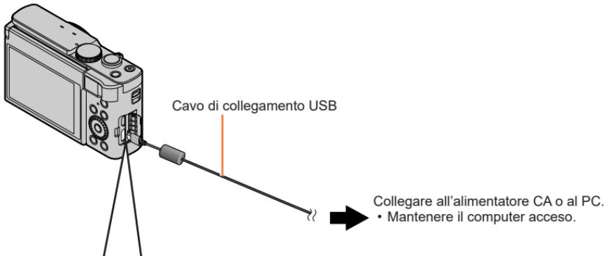
**Quando si carica la fotocamera, collegare il cavo di collegamento USB alla presa [USB/CHARGE].**
