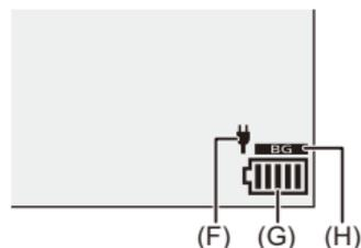
(F) Cavo di collegamento USB che fornisce alimentazione
