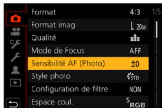
**+** Lorsque la distance avec le sujet change de façon importante, l'appareil photo refait immédiatement la mise au point. Vous pouvez faire la mise au point sur différents sujets, l'un après l'autre.
