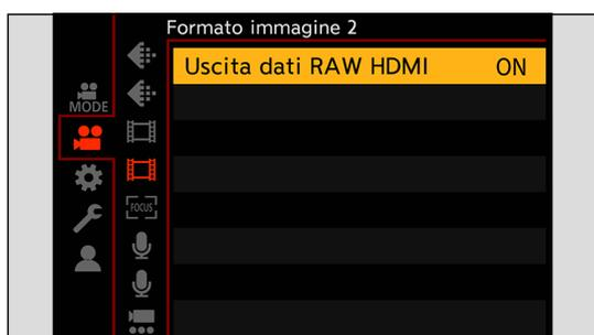
Dopo aver impostato [Uscita dati RAW HDMI] su [ON], visualizzare la schermata del menu con un monitor SDI o con un PC su cui sia installato “LUMIX Tether” e far funzionare la fotocamera.
