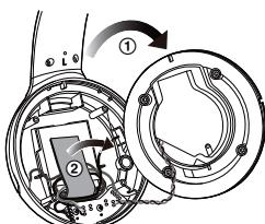
**4 Remova os 2 parafusos, e depois a bateria e a placa.**
