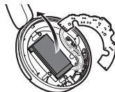
5 По очереди отрежьте кабели, выходящие из аккумуляторной батареи, а затем извлеките ее.
