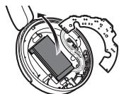
5 Corte los cables de la batería uno a uno y extraiga la batería.
