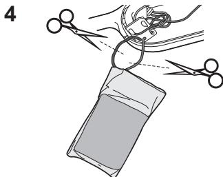
Le seguenti istruzioni non sono destinate a interventi di riparazione bensì allo smaltimento dell'unità. L'unità non è ripristinabile una volta smontata. Durante lo smaltimento, rimuovere la batteria installata nell'unità e riciclarla.
