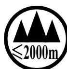
标识含义: 加贴该标识的设备仅按海拔 2000 m 进行安全设计与评估, 因此, 仅适用于在海拔 2000 m 以下安全使用, 在海拔 2000 m 以上使用时, 可能有安全隐患。
