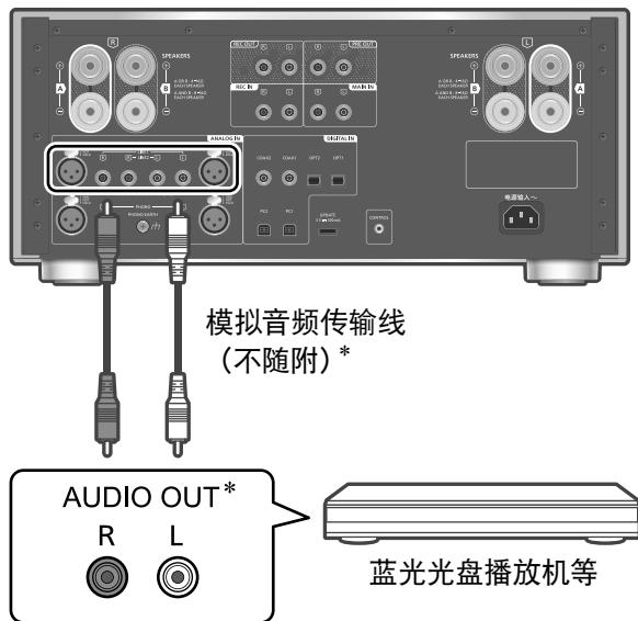
\*: 该图展示了用模拟音频传输线连接的示例。您也可以使用 XLR 连接线连接设备。
