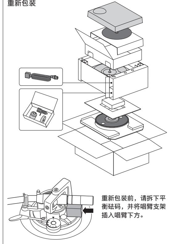
重新包装前，请拆下平衡砝码，并将唱臂支架插入唱臂下方。
