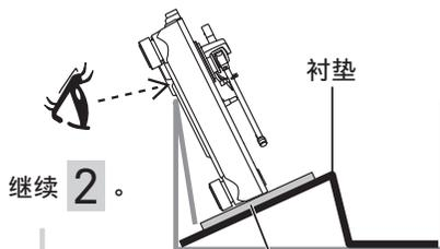
为避免损坏唱机，请用软布盖在唱机的可接触部分，或者用保护纸包裹唱机。
