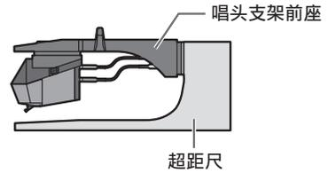
② 移动唱头，使唱针尖对准超距尺的末端。
