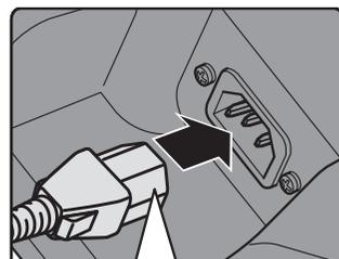
将 AC 电源线插入至圆孔前的位置。
