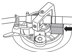
重新包装前，请拆下平衡砝码，并将唱臂支架插入唱臂下方。
