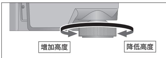
请将主机抬起，转动绝缘体以调整高度。
