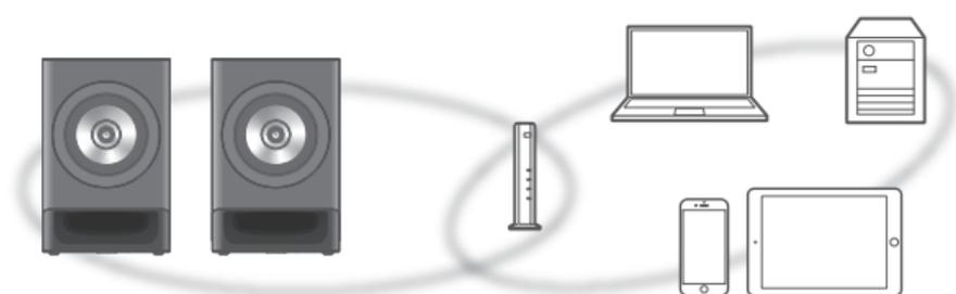
Cet appareil peut être connecté à un routeur à l'aide d'un câble réseau ou du Wi-Fi® intégré.
