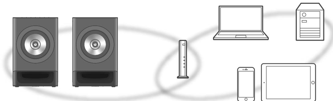
Cet appareil peut être connecté à un routeur à l'aide d'un câble réseau ou du Wi-Fi® intégré. Pour obtenir une connexion au réseau stable, une connexion LAN filaire est préférable.
