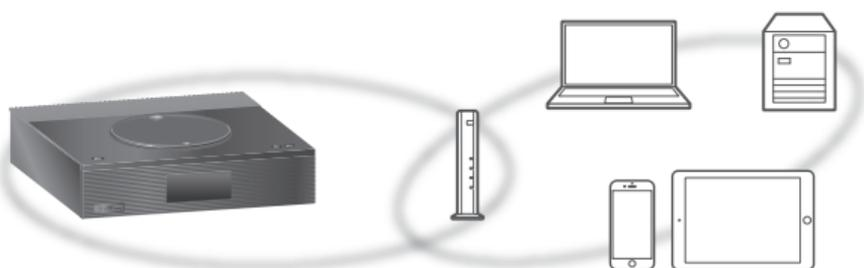
Cette unité peut être connectée à un routeur à l'aide d'un câble réseau ou du Wi-Fi® intégré.
