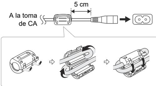
**Sujeción del núcleo de ferrita al terminal**
